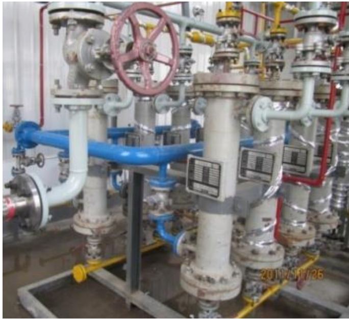
沼气脱CO 2 膜分离示范装置
